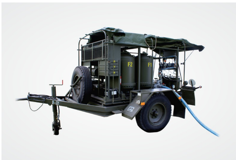
Fot. Przykład stacji uzdatniania wody.
