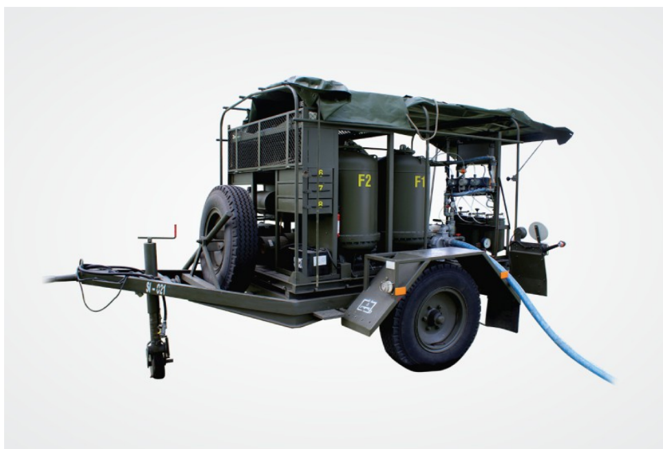
Fot. Przykład stacji uzdatniania wody.
